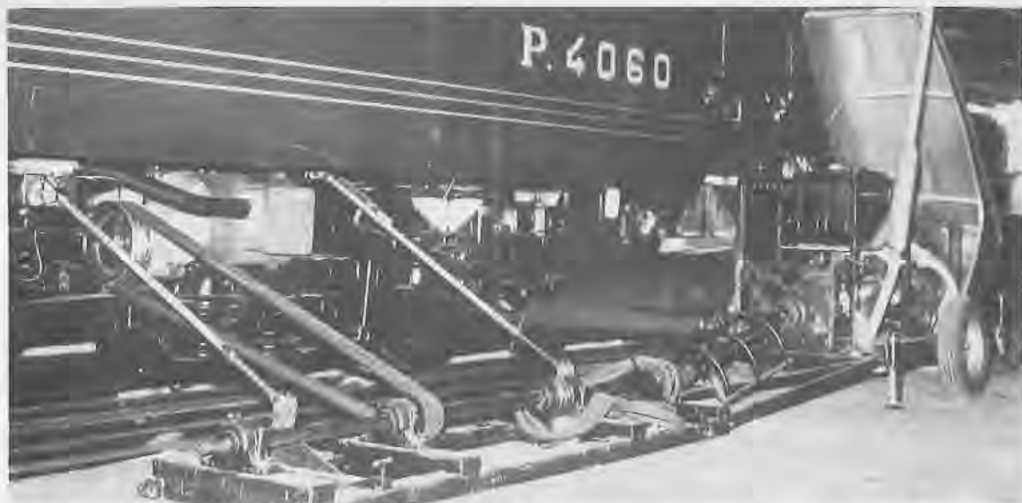
Un motor a explosión del tipo Fiat 125 sirve para generar el movimiento rotativo que posibilita la prueba de los sistemas eléctricos sin que el coche se encuentre en movimiento.
